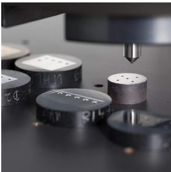
Bsp.: Automatisierter Prüfablauf durch x-y Kreuztisch
