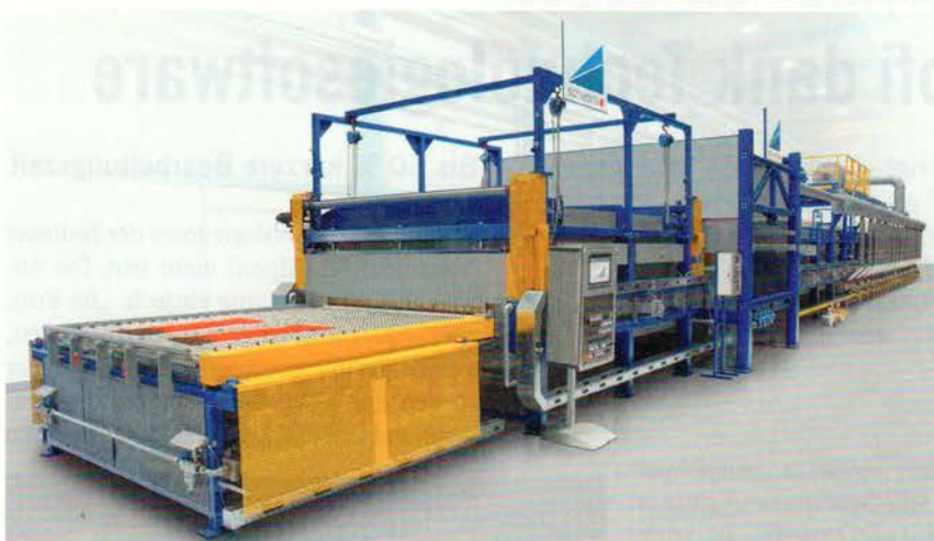
Bild 2. Rollenherdofen mit „Thermischem Printer“ zur Wärmebehandlung von Karosserieteilen.
