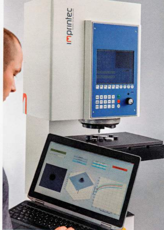
Bild 1. Die Prüfmaschine „I3dTest“ ermittelt mit der dreidimensionalen Vermessung von Härteeindrücken die R_{p0,2} -Dehngrenze und die Zugfestigkeit. Die Prüfmethode lässt sich auch in Fertigungsprozesse integrieren.
