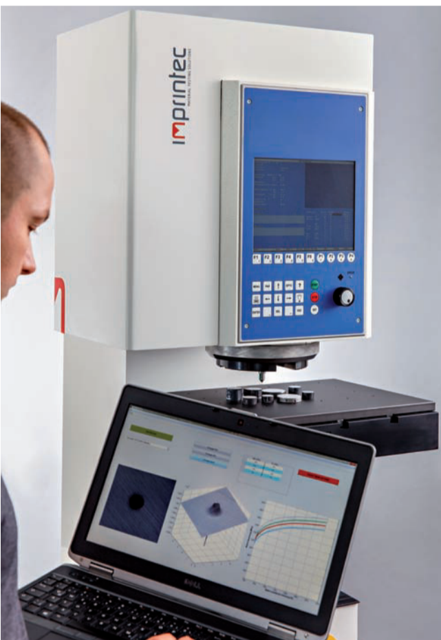
Die Prüfmaschine I3dTest von Imprintec ermittelt mithilfe der dreidimensionalen Vermessung von Härteeindrücken die Rp02-Dehngrenze und die Zugfestigkeit. Die Prüfmethodik lässt sich wie herkömmliche Härteprüfung auch in Fertigungsprozesse integrieren.
